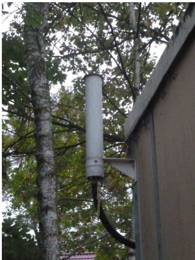
Obr. 8 - Sonda firmy Eberline FHZ621 k měření prostorového dávkového ekvivalentu umístěná na staničce radiační kontroly okolí
